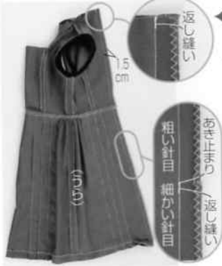
①おもて同士を合わせて後ろ中心線を縫う。あき止まりからは粗い針目のミシンで縫う。
