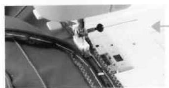
⑤ミシンの押さえ金をコンシールファスナー押さえにする。左後ろ中心線の縫い代を広げて左の溝にファスナーの務歯をはめ、指で務歯を広げながら縫う。上から返し縫いをして縫い始め、縫えるところまで縫ったら返し縫いをする。
