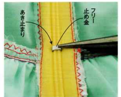
11. フリー止め金をあき止まりの位置に上げ、ペンチで固定する。
