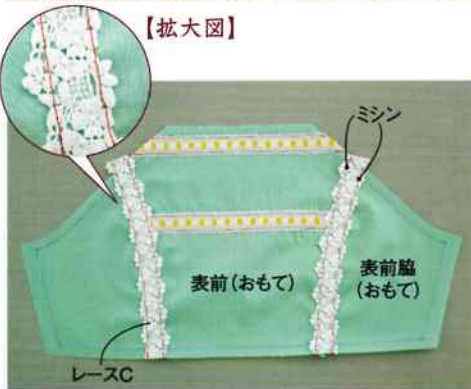
6. 切り替え線にレースCを重ねて、レースのきわをミシンで縫う。
