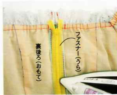
2. ファスナーの中心と後ろ中心を合わせ、アイロンで下まで接着する。(接着テープを使わない場合はしつけ糸でファスナーと後ろ中心の縫い代を縫う)
