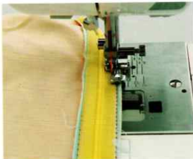
3. ファスナーの端と後ろ中心の縫い代を縫う。縫いにくい場合はファスナー押え等に変えて縫う。
