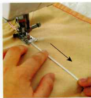
8. ゴムテープBと袖の合印同士を合わせ、まち針でとめる。ゴムテープBを伸ばしながらミシンで縫う。
