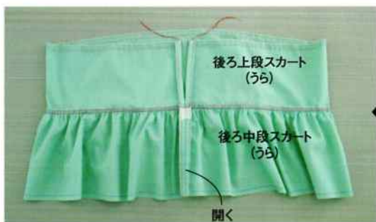
10. 後ろスカートのおもて同士を合わせて、後ろ中心線をあき止まりまで縫い、縫い代を開く。
