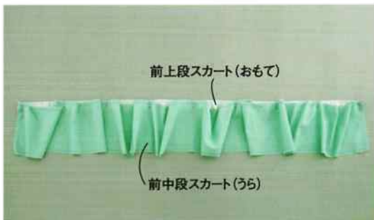
7. 上段スカートと中段スカートのおもて同士を合わせて、合印同士をとめる。
