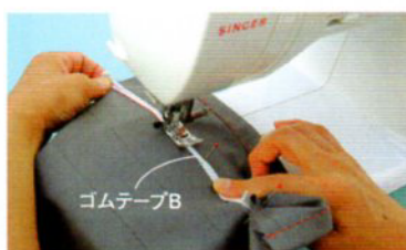
5. 返し縫いをして、つけ位置に合わせてゴムテープBを伸ばしながらミシンで縫う
