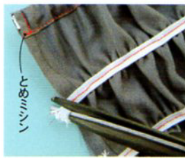
10. 余分なゴムテープBはカットする。ゴムテープAの端はミシンでとめる
