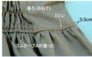
8. 後ろ切り替え位置にゴムテープAが通りました。後ろ脇の切り替えをミシンで縫う
